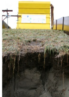
Figuur 2. Proeven op St. Philipsland met de golfoverslagsimulator die een 'doorgebroken dijk' weergeven volgens de huidige implementatie van het faalmechanisme.
