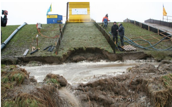
Figuur 1. Proeven bij Kattendijke met de golfoverslagsimulator die een 'doorgebroken dijk' weergeven volgens de huidige implementatie van het faalmechanisme. Een gravelweg erodeerde tot een 10 m breed en 2 m diep gat. Hierna ontstond kliferosie.
