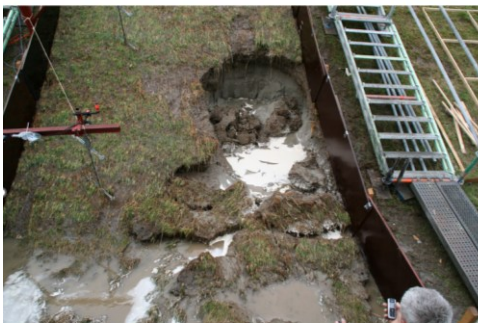
Figuur 2. Proeven op St. Philipsland met de golfoverslagsimulator die een 'doorgebroken dijk' weergeven volgens de huidige implementatie van het faalmechanisme.
